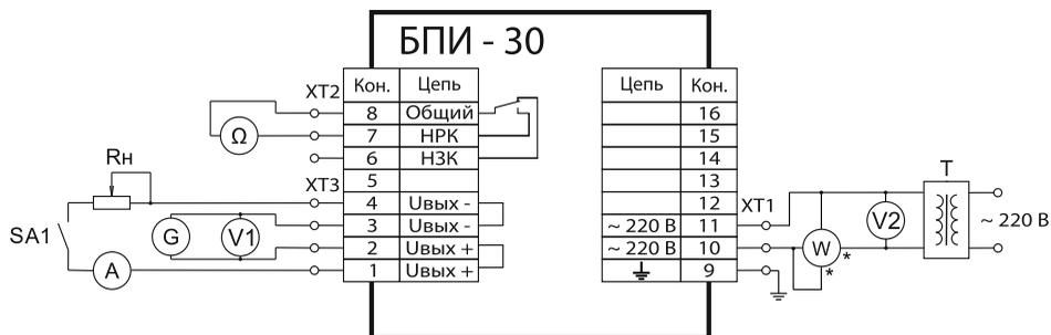
Рисунок Г.1. Схема проверки блоков
