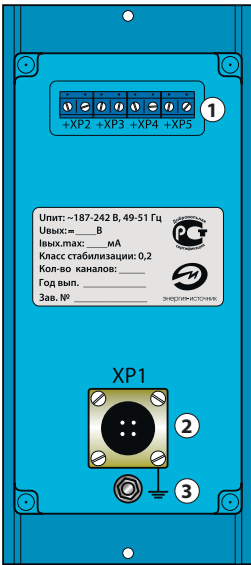
Схема подключения БПМ-1к исполнение DIN
